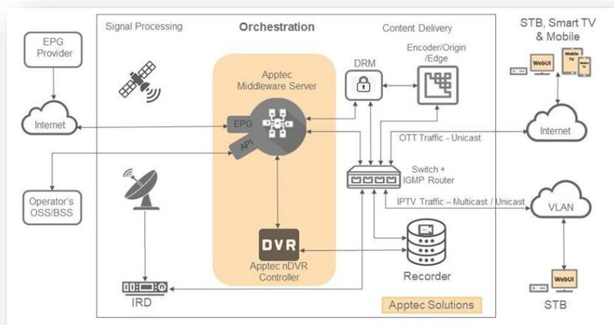
Plataforma típica de IPTV / OTT (Módulos Apptec destacados em bege)
